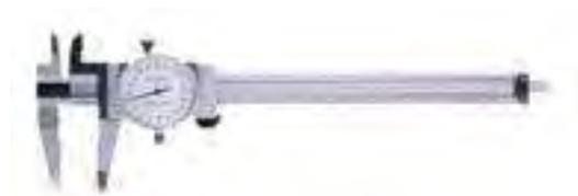
Предназначены для измерения внутренних и внешних размеров
