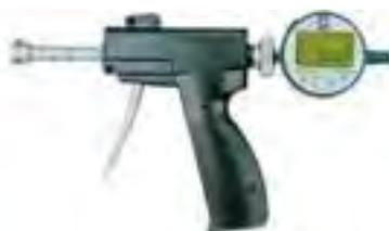
Трехточечные нутромеры pistolетного типа предназначены для точных измерений внутренних размеров. Их технические характеристики соответствуют нутромерам типа НМ-СЦ. Нутромеры pistolетного типа требуют меньше времени на выполнение измерений по сравнению с нутромерами типа НМ-СЦ.
