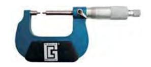
Микрометр с малыми измерительными поверхностями МКДЗ предназначен для измерения диаметра канавок, глубины шлицов и других труднодоступных размеров. Оказывает более высокое удельное давление на измеряемые поверхности при одинаковом измерительном усилии по сравнению с микрометром МК.
