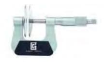
Микрометр с тарельчатыми измерительными поверхностями МКД6 предназначен для измерения мягких материалов. Оказывает более низкое удельное давление на измеряемые поверхности при одинаковом измерительном усилии по сравнению с микрометром МК. Диаметр измерительных поверхностей 60 мм.
