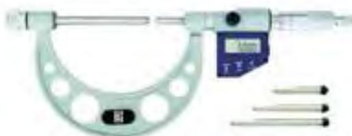
Расширенный измерительный диапазон благодаря переставной пятке. Высокая точность изготовления пятки позволяет не делать повторную настройку после смены диапазона. Твердосплавные измерительные поверхности. Окрашенная скоба. Комбинированная трубная рамка, для уменьшения веса и увеличения прочности. (Только для диапазона более 300мм)
