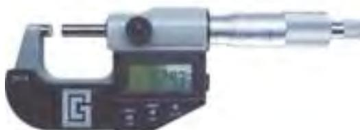
Твердосплавные измерительные поверхности.
