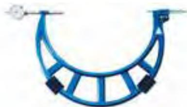
Подвижный индикатор для увеличения измерительного диапазона и уменьшения погрешности. Цена деления индикатора 0,01мм. Диапазон измерения индикатора 5 мм.
