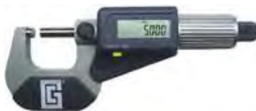
Микрометры с электронным цифровым отсчетным устройством МКЦ предназначены для измерения наружных размеров до 200мм. Твердосплавные измерительные поверхности. Фрикцион.
