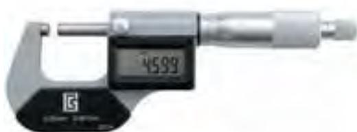
Твердосплавные измерительные поверхности. Трещотка. Переключение мм/дюймы. Степень защиты IP54
