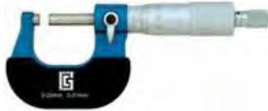
Твердосплавные измерительные поверхности.
