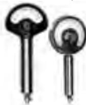
Микрокатор предназначен для точных измерений линейных размеров, а также отклонений от заданной геометрической формы. Может быть использован в универсальной стойке СИ, СП или в измерительных приспособлениях с присоединительным диаметром 28 мм.
