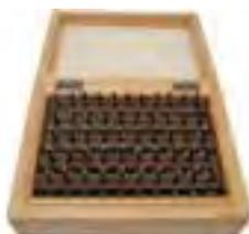
Применяются для измерений отверстий, для настройки, поверки и калибровки измерительных приборов.
