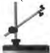
Стойки и штативы магнитные предназначены для закрепления индикаторных головок при контроле радиального и/или торцевого биения, а также при выполнении измерений деталей.
